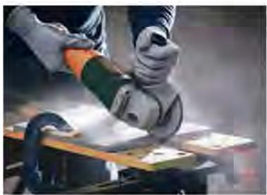
In aggiunta, il sistema di ovvio graduale "Soft Start" garantisce una partenza più dolce del motore e una progressione graduale della potenza in accensione, accrescendo ulteriormente il controllo sul prodotto e la sicurezza in uso.
